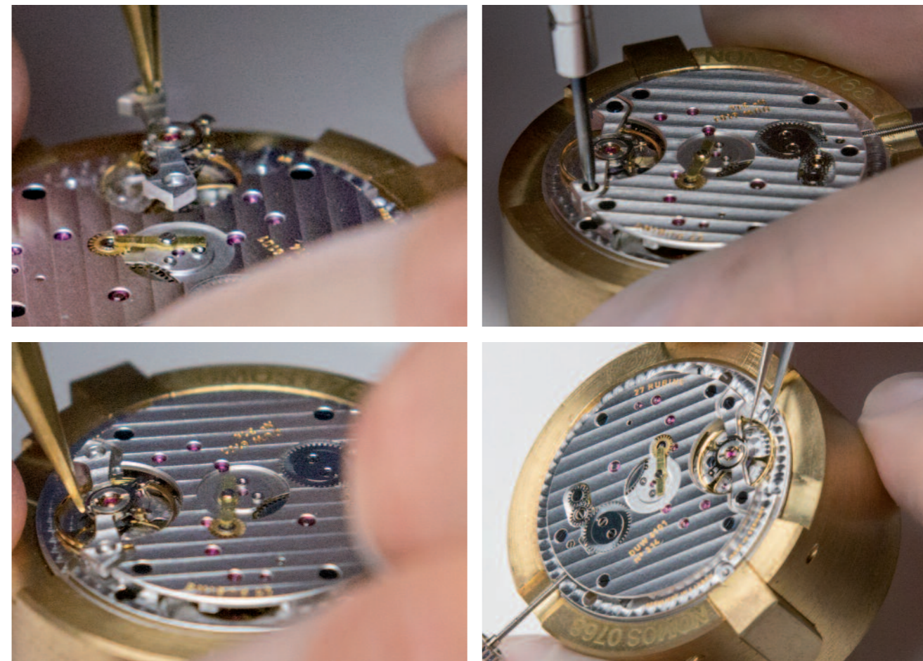
Il montaggio dello Swing System, lo scappamento interamente progettato e realizzato (molla del bilanciere compresa) dalla Casa tedesca.
