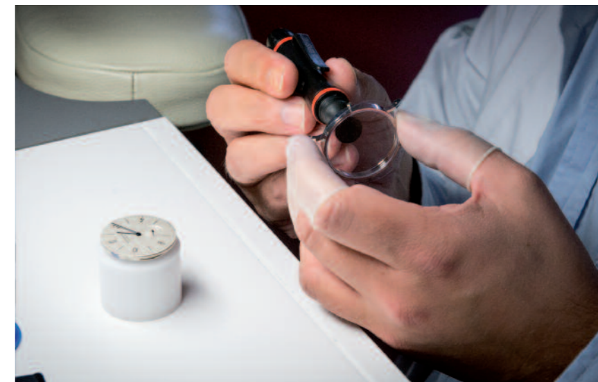
L'incassaggio di un orologio, nella manifattura di Glashütte. AL CENTRO: Il fissaggio della spirale alla viola, nella produzione dello Swing System. IN BASSO: La fresatura delle platine negli impianti Nomos per la produzione dei componenti.
